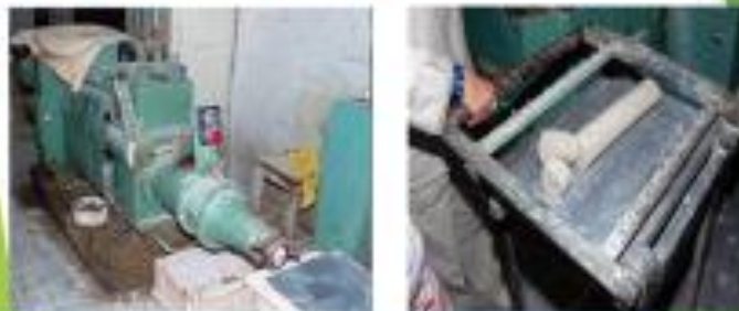
Из такой машины выходит "колбаса" фарфорового теста
