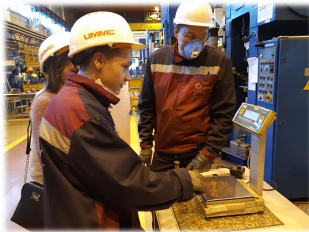
**Измерение массы заготовок после прессования. Весы «Sartorius»**
