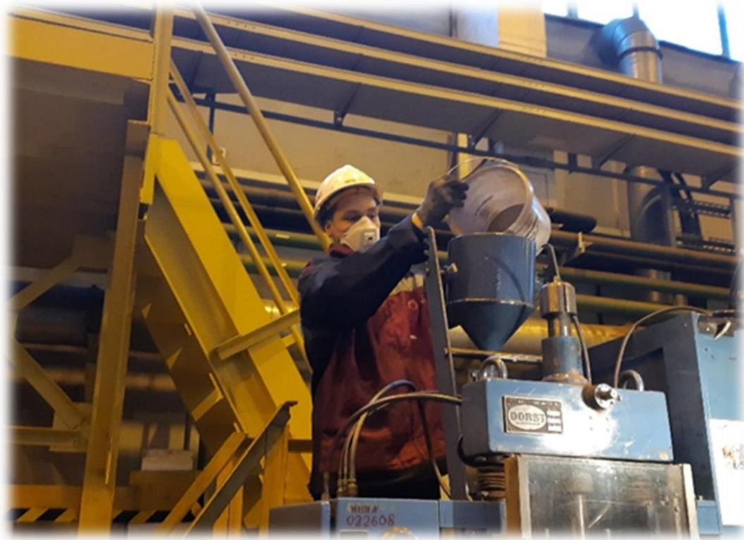
**Засыпка опытных образцов в бункер**
