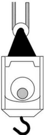
Одна из главных трудностей в работе на подъемном кране - раскачивание и вибрация груза из-за порывов ветра, инерции груза при поворотах крана, неравномерность поднимания или опускания крюка (при частом переключении лебедки груз дергается). Эта низкочастотная вибрация передается через тросы на металлические конструкции крана и даже может привести к аварии. Кроме того, крановщик теряет время, дожидаясь, пока груз " успокоится ", особенно, если его надо подать через узкий проем.
