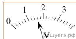
Запишите показания вольтметра с учётом абсолютной погрешности измерений. Абсолютная погрешность прямого измерения напряжения равна цене деления вольтметра. В ответе запишите значение и погрешность слитно без пробела.
